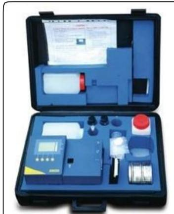
Appareil de mesures (potentiel REDOX, T°, Ph)
